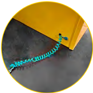
Sistema de continuidad eléctrica.
