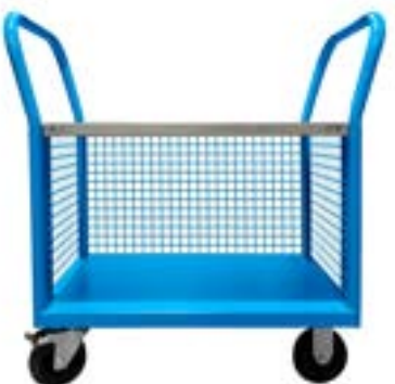
Código Art. FCF H005 08 Cap. de Carga 250kg. Dimensões: 945x525x1045 H mm. Carrinho com 2 rodas giratórias COM freio e 2 rodas fixas de Ø150 mm borracha padronizada
